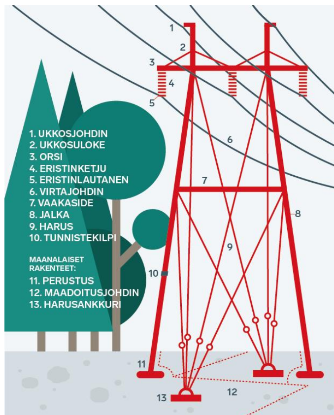
Kuva 6-4. Voimajohdon osat (Fingrid, 2022).
